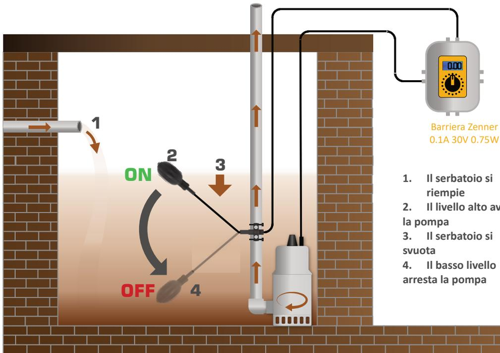
Grazie alla carica particolare di Carbon Black, le cariche elettrostatiche che potrebbero scaturirsi nell'impianto vengono trasferite all'esterno attraverso il filo di terra del galleggiante.
