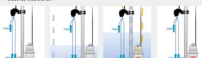
El Snake está conectado a 3 sondas de nivel: Común para la tierra - Mín para el nivel mínimo y Máx para el nivel máximo
