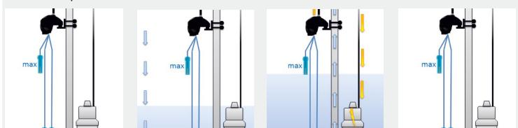
Le Snake est connecté à 3 sondes de niveau: Commune pour la masse – Min pour le niveau de minimum et Max pour le niveau de maximum
